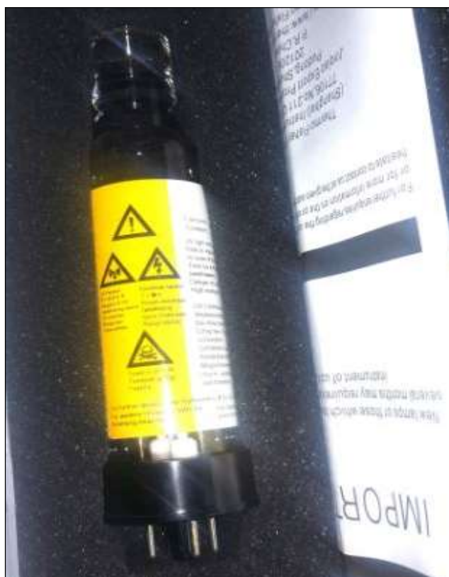
Imagen 4. Lámpara de cátodo hueco.
