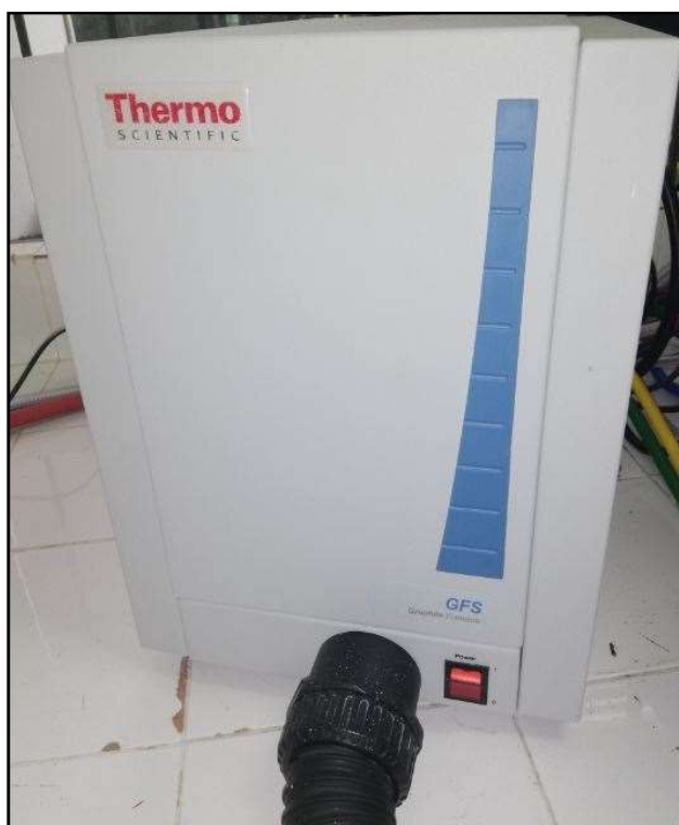
Imagen 3. Módulo de suministro de argón.
