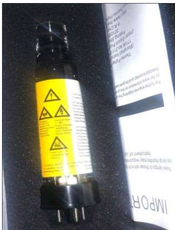
Imagen 5. Lámpara de cátodo hueco.
