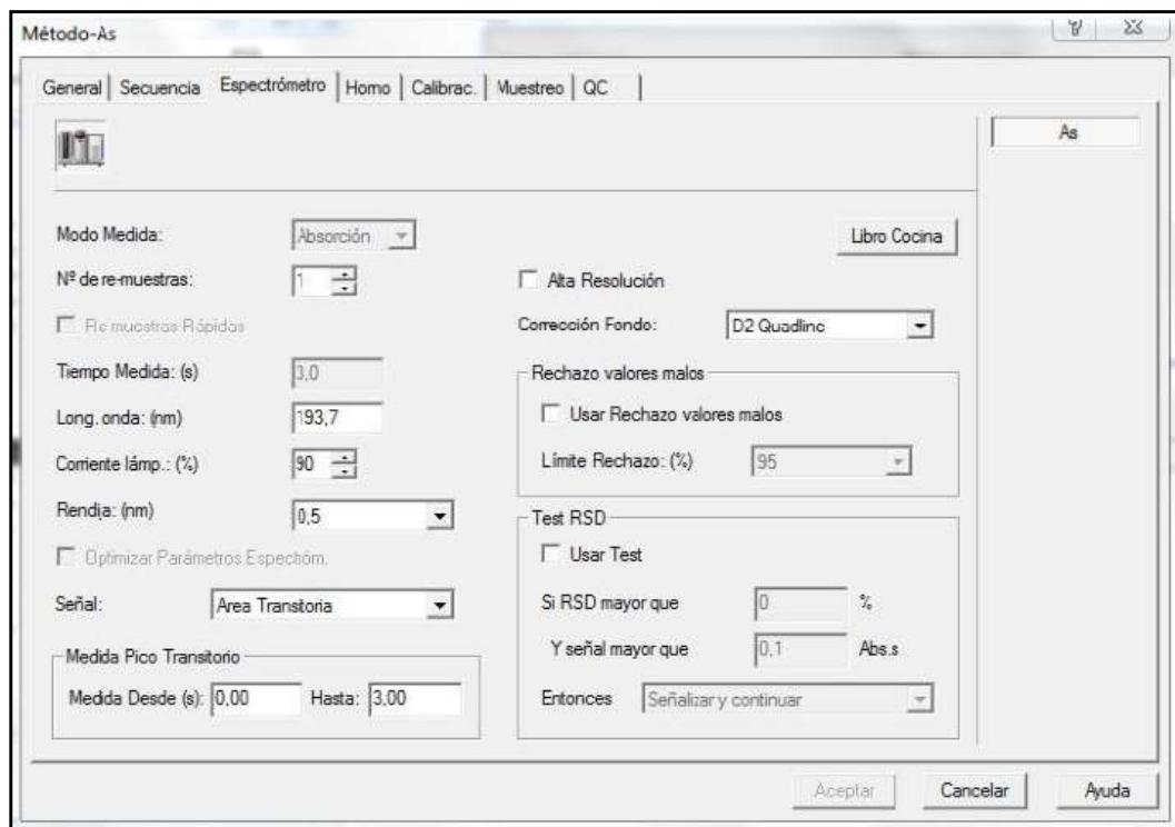
**Imagen 1. Configuración espectrómetro. Aguas superficiales, subterráneas, potables y residuales**
