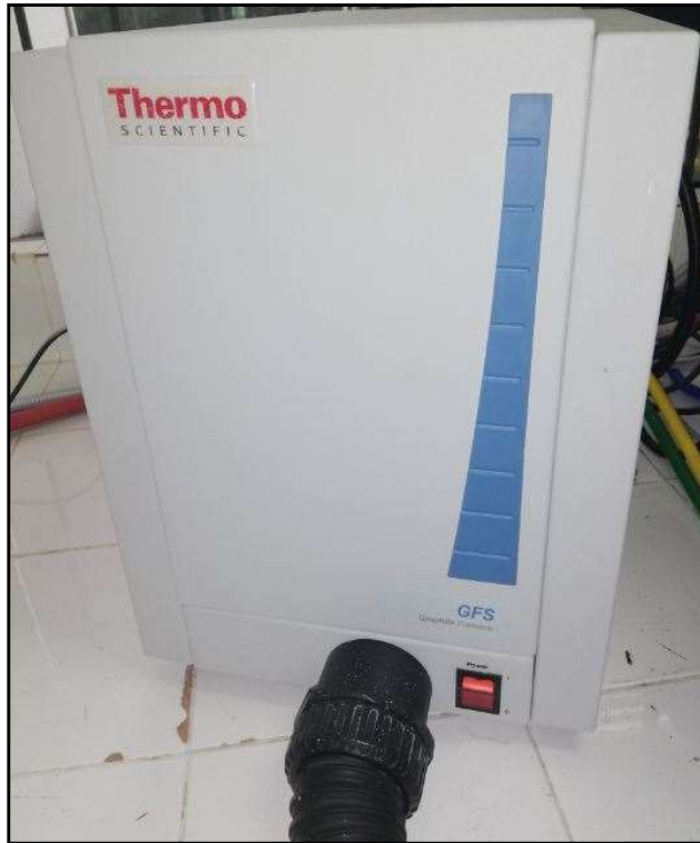
Imagen 3. Módulo de suministro de argón.
