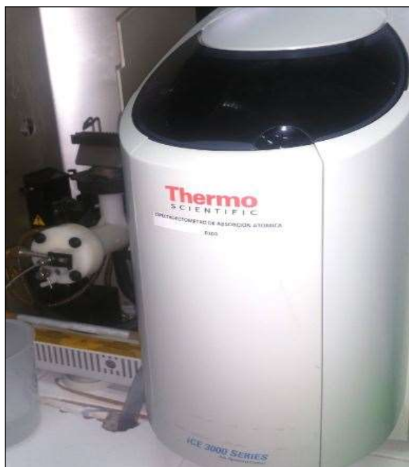
Imagen 2. Espectrómetro A.A. Thermo Scientific ICE 3000.
