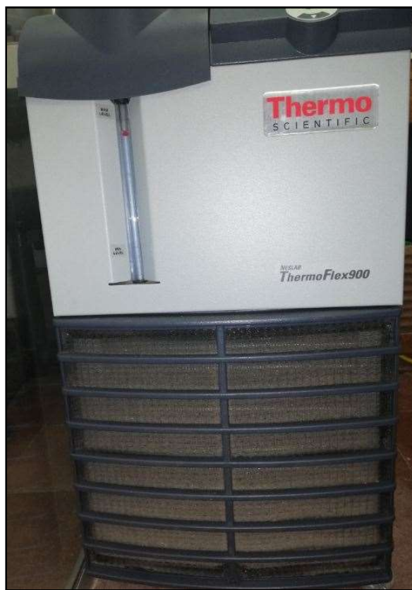
Imagen 1. Enfriador de agua.
