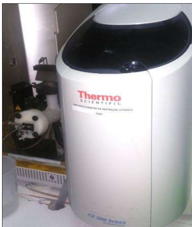
Imagen 2. Espectrómetro A.A. Thermo Scientific ICE 3000.
