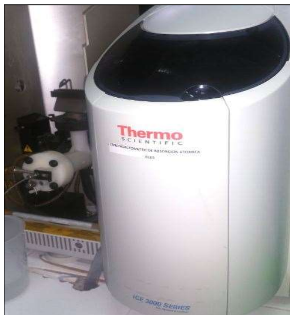
Imagen 2. Espectrómetro A.A. Thermo Scientific ICE 3000.
